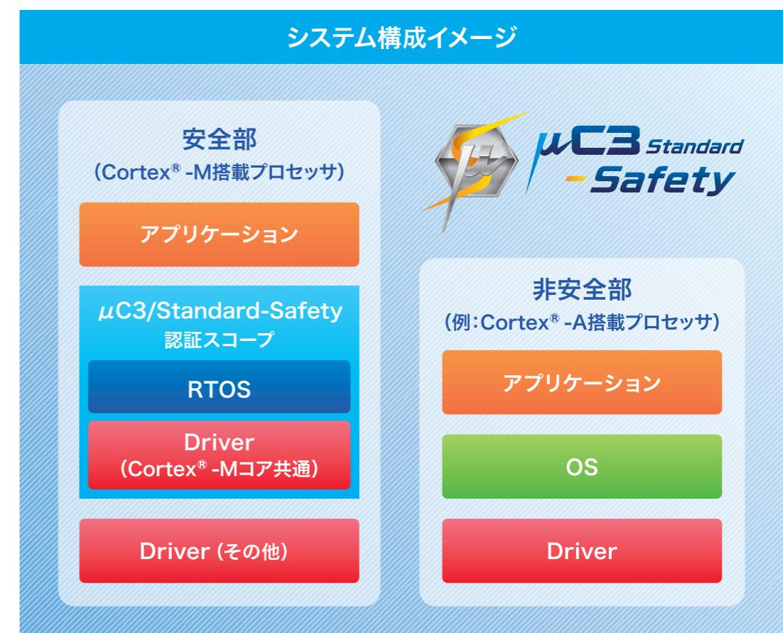
一般的な機能安全システムの場合は安全部のみで構築することもありますが、大規模なシステムの場合は安全部と非安全部を分けて構築するのが一般的です。また、安全部はリアルタイム性が必要な処理を行うため、Cortex® -Mを採用することが多く、μC3/Standard-Safetyを利用をすることも可能です。
