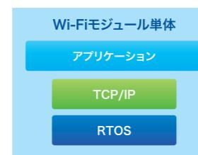
CPU内蔵WLANモジュール単体での動作もでき、CPUをマイコンのように使用し、SPIやI2Cなどで周辺デバイスの制御も可能
