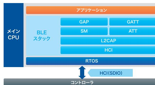
BLEアーキテクチャは一般的に、アプリケーション層・ホスト層・コントローラ層に分類されており、イー・フォースのBLEスタックはホスト層の機能を提供しています。HCIをサポートした、BLE Controller Subsystemと組み合わせて使用します。
